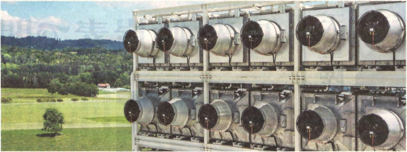
巨大装置で大気中のCO<sub>2</sub>を回収(スイス北部) 川クライムワークス提供
