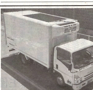
セブンイレブン・ジャパンが導入を進める太陽電池搭載トラック
